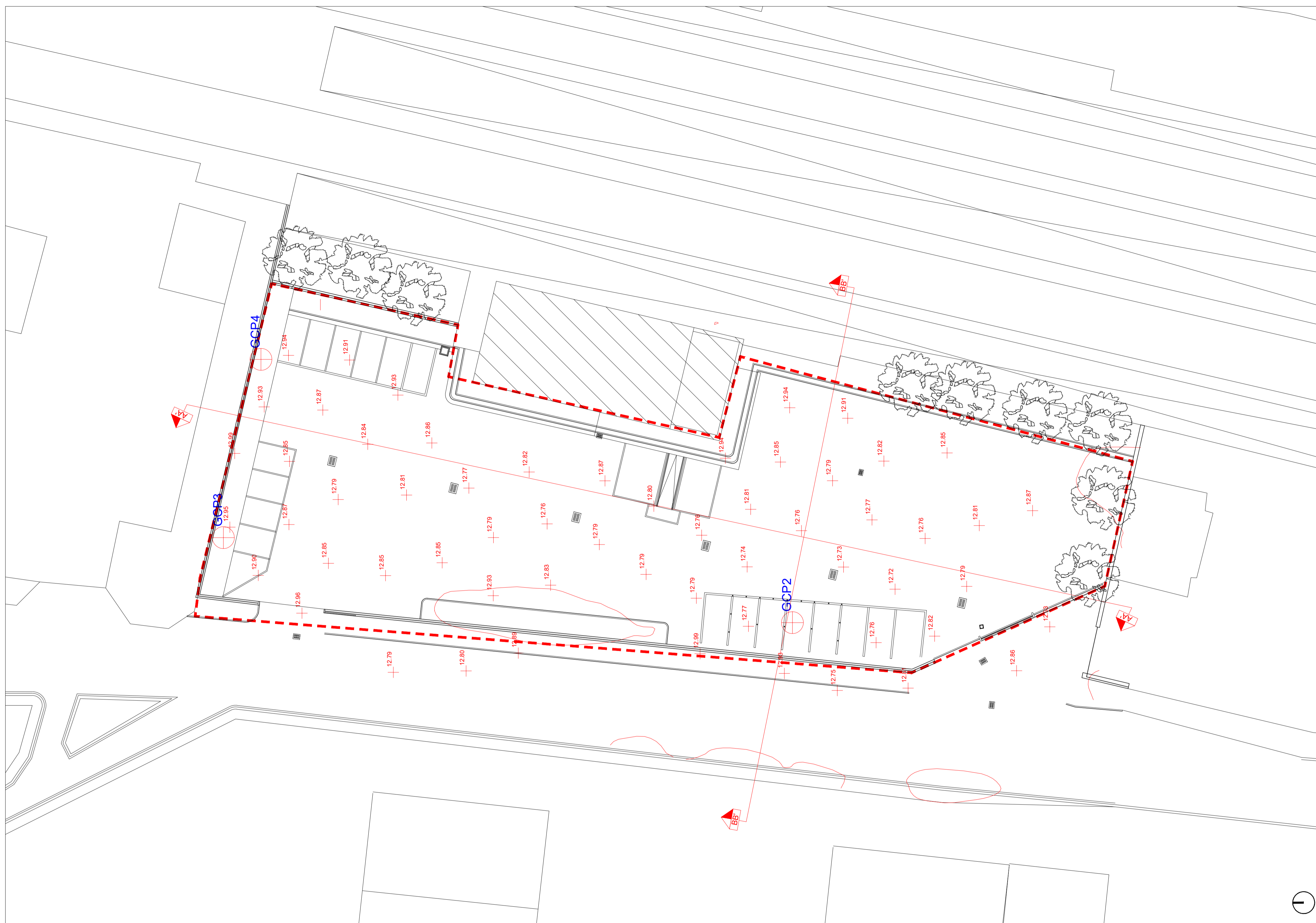
Rilievo piano altimetrico - stato di fatto - scala 1:200
